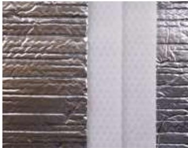
1. Film aluminium pur à 99% et 30 microns d'épaisseur
