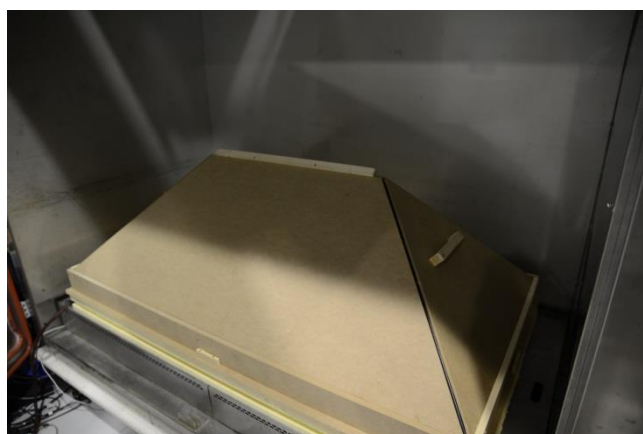
Figure 12 - Structure isolée recouverte de la réplique de toiture
