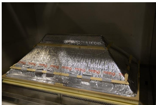
Figure 11 - Structure isolée au moyen d'une couche d'Aluthermo Quattro®
