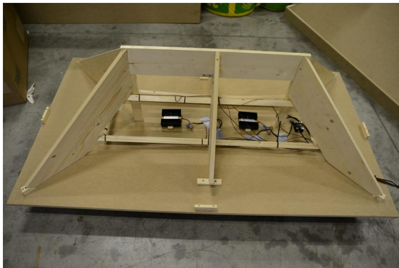
Figure 2 – Structure de base et système de chauffage
