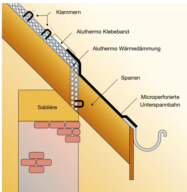
Die erste Aluthermo®-Bahn wird parallel zur Traufe ausgerollt. Um eine spätere Verbindung zwischen Aluthermo® und dem Fußgebälk zu ermöglichen muss der untere Rand der Aluthermo®-Bahn den Fuß ausreichend überlappen.
