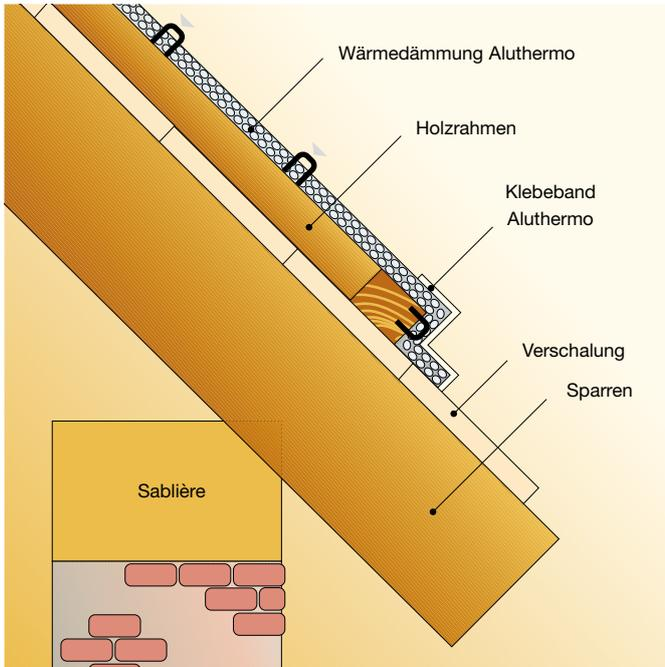
Das Aluthermo® wird abgerollt und auf diesem Rahmen fixiert. Der untere Rand der Aluthermo®-Bahn wird in Abständen von jeweils 5 cm mit Klammern auf der senkrechten Seite der Fußlatte fixiert. Diese Verbindung wird dann mit dem Aluminium-System-Klebeband abgedichtet.
