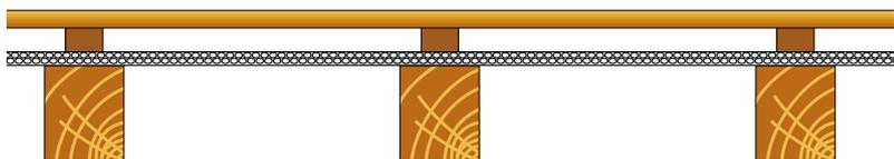
Die Aluthermo® -Bahnen werden abgerollt und auf dem hölzernen Gerüst mit Klammern befestigt. Die Überlappungen werden mit dem mitgelieferten Aluminium-System-Klebeband dicht verklebt.
