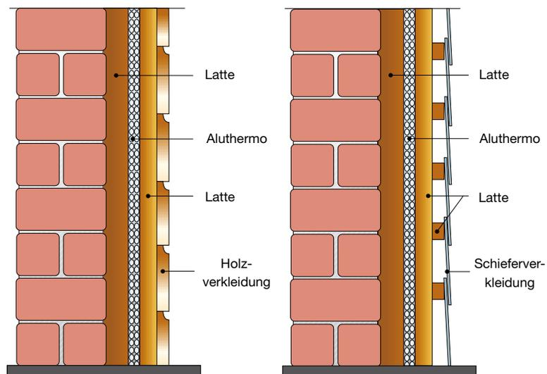
Auf der zu dämmenden Wand wird zuvor ein Rahmen aus 30 mm ( 40 mm für das Aluthermo Optima® ) dicken und 5 cm breiten Latten montiert. Auf diesem werden die Aluthermo®-Bahnen mit min. 5 cm Überlappung horizontal verlegt.
