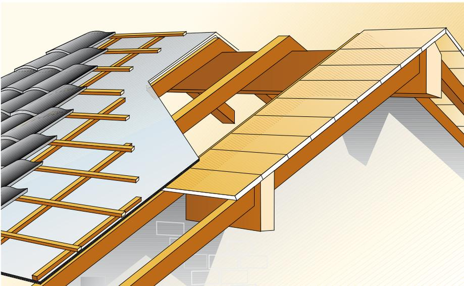
Die Aluthermo®-Bahn wird provisorisch mit Klammern am ersten, außerhalb des Giebels liegenden Sparren fixiert.
