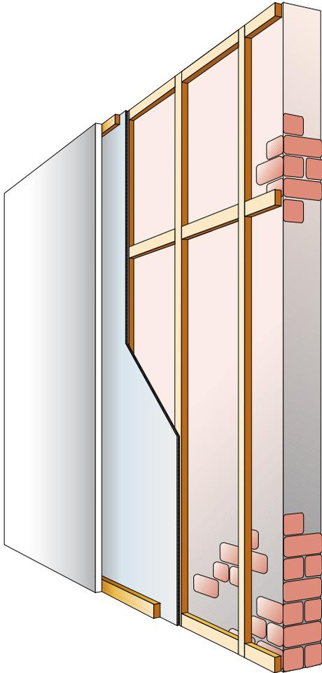
Auf der zu dämmenden Wand wird zuvor ein Rahmen aus 25 mm dicken (40 mm für Aluthermo Optima) und 5 cm breiten Latten montiert. Auf diesem werden die Aluthermo®-Bahnen mit min. 5 cm Überlappung horizontal oder vertikal verlegt. Die Überlappungen und Fugen werden mit dem mitgelieferten Aluminium-System-Klebeband abgedichtet.
