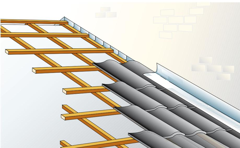
Die Aluthermo®-Bahn wird so aufgelegt, dass sie sich um  $\pm 5$  cm nach oben zurückfalten lässt. Das Material wird mit Klammern am ersten Dachsparren befestigt und mit der Konterlatte an die Wand gepresst.
