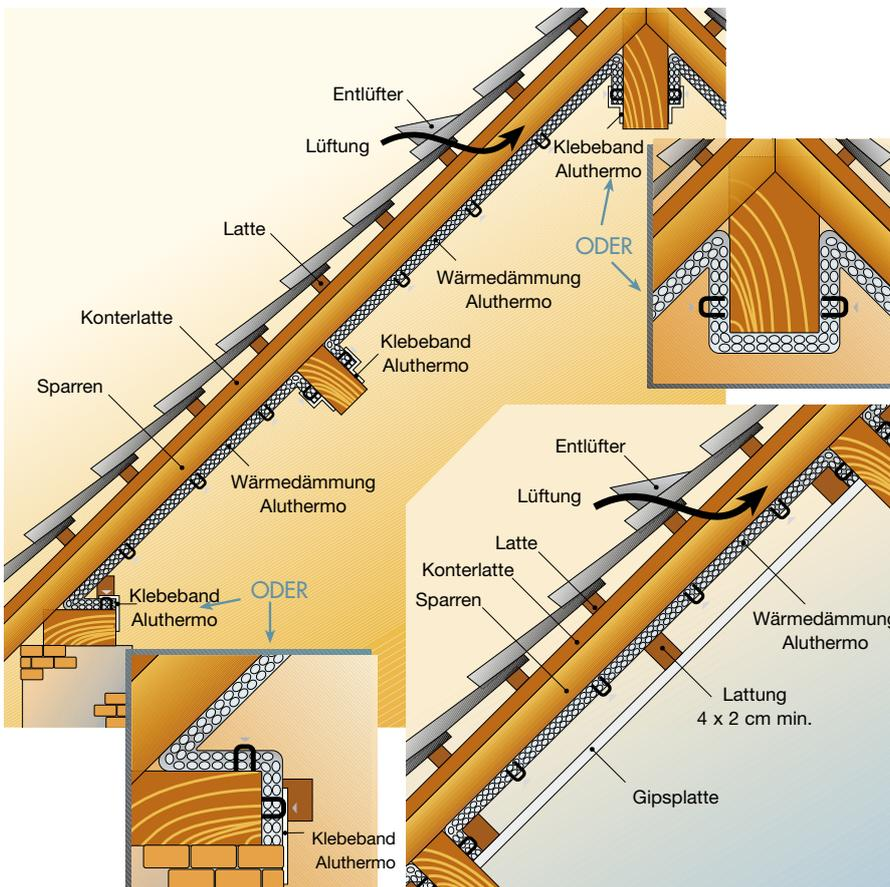
Die folgenden Aluthermo®-Bahnen werden mit min. 5 cm Überlappung verlegt. Die Überlappungen sind mit dem mitgelieferten Aluminium-System-Klebeband abzudichten.
