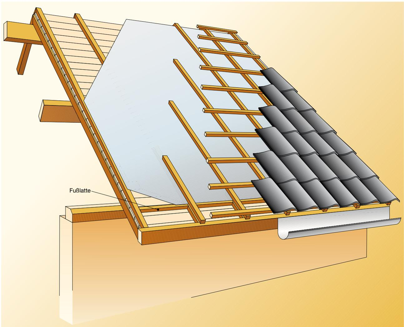
Um eine stabile Luftschicht zwischen Aluthermo® und Verschalung zu bilden wird ein Rahmen aufgelegt.
