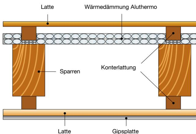
Bei der Aufsparrendämmung wird Aluthermo® – am Fuß beginnend – waagrecht auf den Sparren abgerollt und auf diesen zunächst provisorisch mit 20 mm langen Klammern fixiert.
