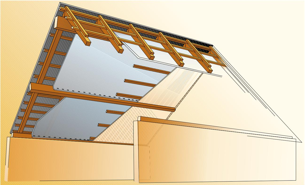
Die erste Aluthermo®-Bahn wird parallel zum First verlegt und wird 5 cm umgeschlagen und auf der Firstpfette befestigt. Das Aluthermo® wird gespannt und auf den Pfetten und Sparren in Abständen von max. 20 cm mit Klammern befestigt.
