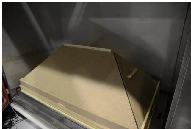
Afbeelding 12 – Geïsoleerde structuur bedekt met het namaakdak
