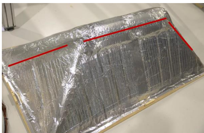
Afbeelding 10 – Isolatie d.m.v. Aluthermo Optima®
