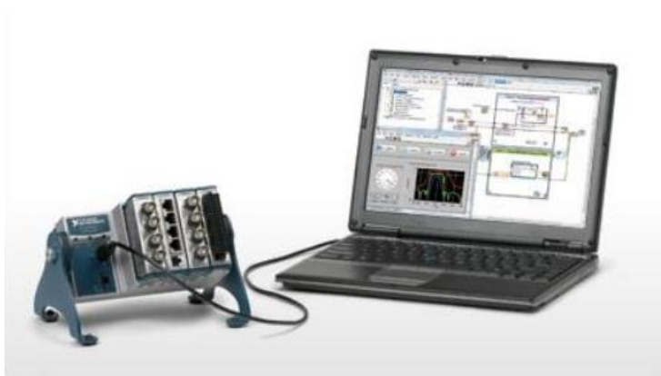
Afbeelding 7 – National Instruments CompactDAQ-systeem
