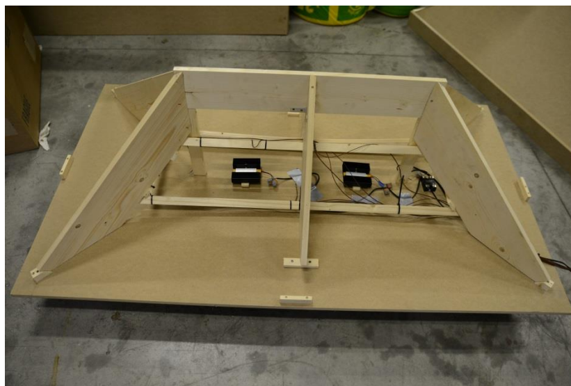
Afbeelding 2 – Houten basisstructuur en verwarmingssysteem
