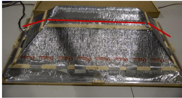
Afbeelding 10 – Isolatie d.m.v. Aluthermo Quattro®
