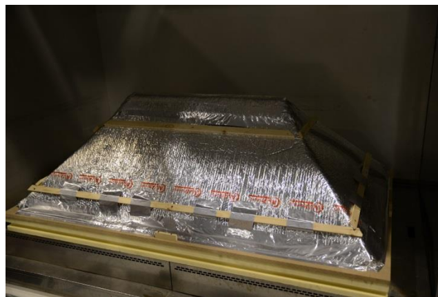
Afbeelding 11 - Structuur geïsoleerd d.m.v. 1 laag Aluthermo Quattro®
