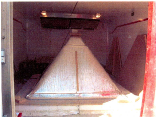
Fig. 4 Aluthermo Quattro ® applied over rafter
