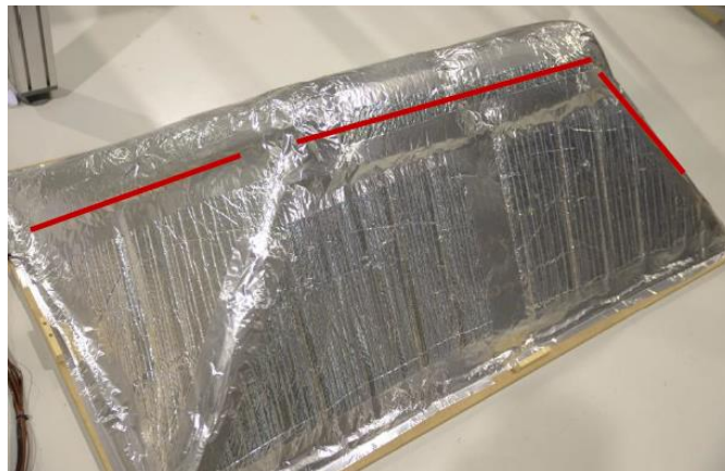
Figure 10 - Isolation au moyen d'Aluthermo Optima®
